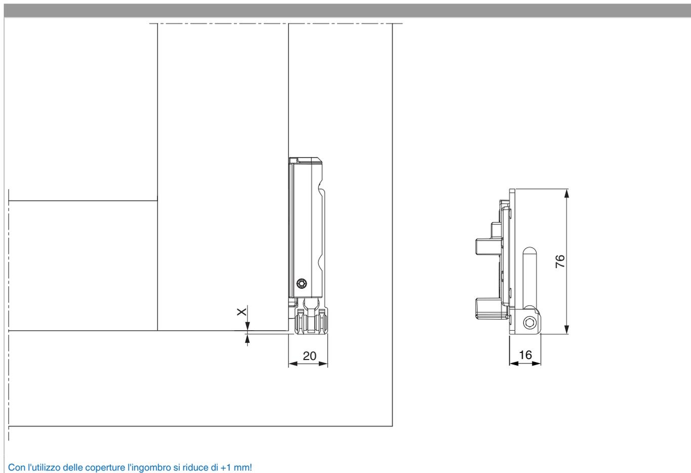
Con l'utilizzo delle coperture l'ingombro si riduce di +1 mm!
