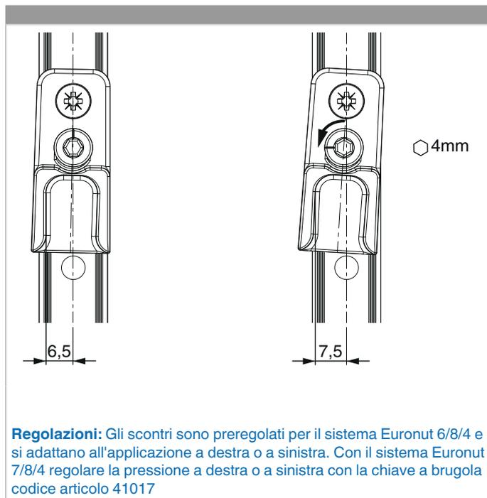
**Regolazioni:** Gli scontri sono preregolati per il sistema Euronut 6/8/4 e si adattano all'applicazione a destra o a sinistra. Con il sistema Euronut 7/8/4 regolare la pressione a destra o a sinistra con la chiave a brugola codice articolo 41017
