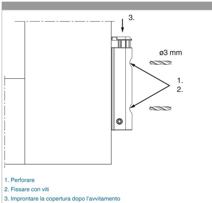
232934 - Angolo cerniera DT130 con fissaggio battuta
