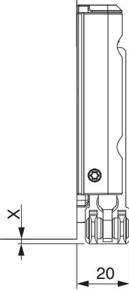
Con l'utilizzo delle coperture l'ingombro si riduce di +1 mm!
