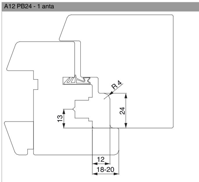
**356333 - Scontro alza anta MultiMatic PB 24 mm scost. 13 mm con vite inclinata destro argento**
